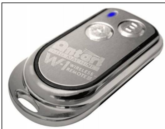
Avec le transmetteur, il est possible de débiter de neige dedans un rayon d'action de 50 mètres. Le transmetteur est compatible avec chaque récepteur de modèle SW-250 Machine à Neige et peut contrôler des machines illimitée en même temps. Pour dégager la neige, appuyez sur la bouton "A". Comme contrôle, la LED bleu et allumée. Pour désactiver le débit de neige, appuyez sur la bouton "B".
